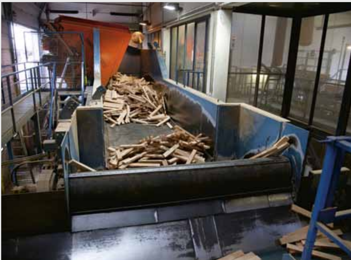
Hos Junckers står der i dag seks kombinerede presse/tørringsanlæg hvoraf det ene er forsynet med sit eget meget store, meget omkostningskrævende og delvist automatiske fødningsystem. Dette anlæg, der ses her på billedet, står lidt for sig selv.
