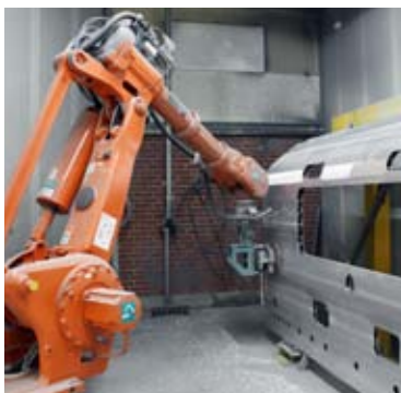
Den seksaksede 3,15-ABB-robot i gang med at bearbejde et af panelerne til undergrundstoget Victoria Line i London, der skal stå klar inden Ol 2012.
